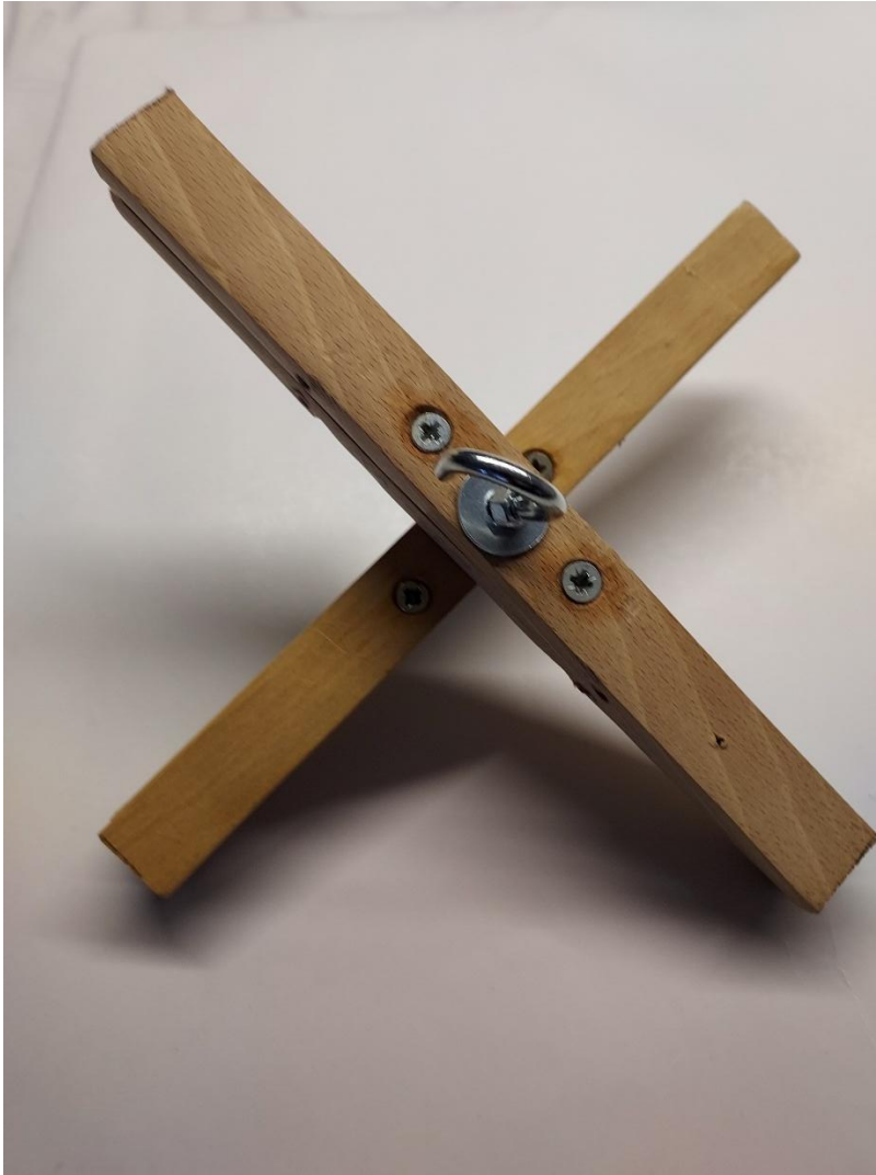
Eigengemaakt "Houthakkerskruis". Om hoogte en lengte van een boom op te meten.
